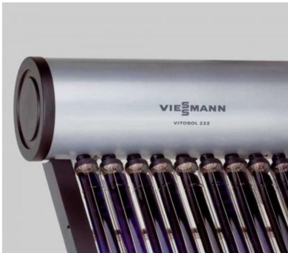
Οι Ηλιοθερμικοί συλλέκτες με σωλήνες κενού βασίζονται στην τεχνολογία “heat pipe” (χάλκινου αυλού). Αποτελούνται από διπλούς γυάλινους σωλήνες διαχωριζόμενους από κενό αέρος. Η εσωτερική σωλήνα είναι βαμμένη με θερμοαποροφητικό υλικό χαμηλής αντανάκλασης. Ο συλλέκτης μετατρέπει την ηλιακή ακτινοβολία σε θερμότητα. Το κενό αέρος ανάμεσα στους 2 σωλήνες
